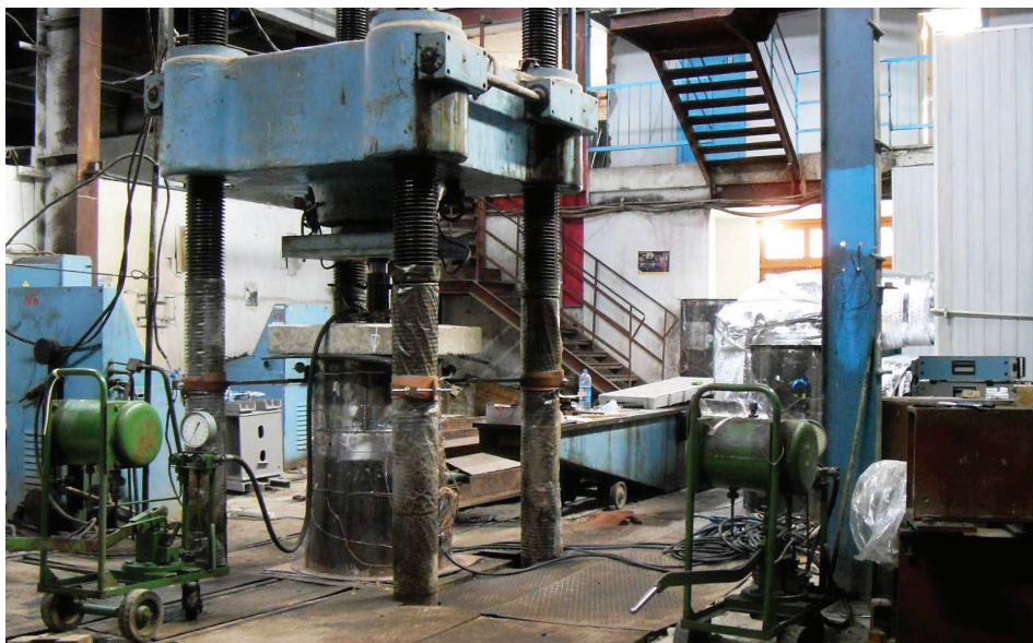
Рис. 6. Общий вид экспериментальной установки для исследования локальных напряжений
