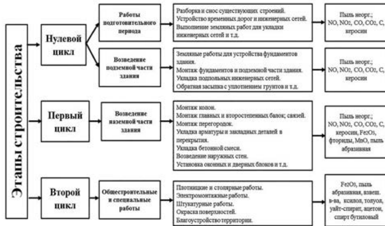
Рис. 1. Источники загрязнения атмосферного воздуха на строительных площадках в зависимости от этапа строительства
