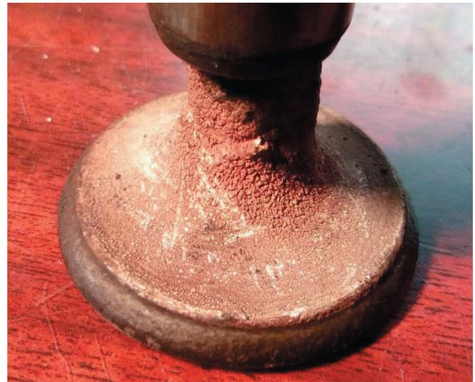
Рис. 4. Характерный вид нижней части стержня и тыльной стороны тарелки выпускного клапана двигателя ЗМЗ-402
