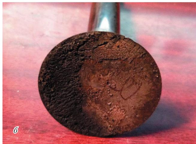
Рис. 6. Впускной клапан дизельного двигателя Д-240: состояние рабочей фаски тыльной стороны тарелки (а) и днище тарелки (б)
