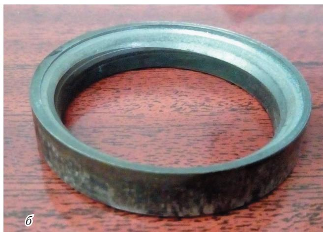
Рис. 5. Выпускной клапан ЗИЛ-508 с направляющей (а) и седло клапана (б)
