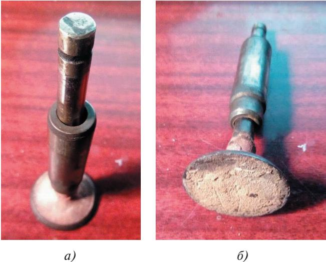
Рис. 2. Общий вид пары «выпускной клапан – направляющая втулка» двигателя ЗМЗ-402, отработавшего ресурс на КПП (а) и характерный вид состояния поверхности дна тарелки выпускного клапана (б)
