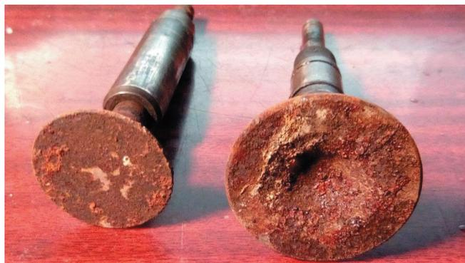
Рис. 1. Внешний вид выпускного (слева) и впускного (справа) клапанов газораспределительного механизма двигателя ЗМЗ-5234, отработавшего ресурс на КПГ
