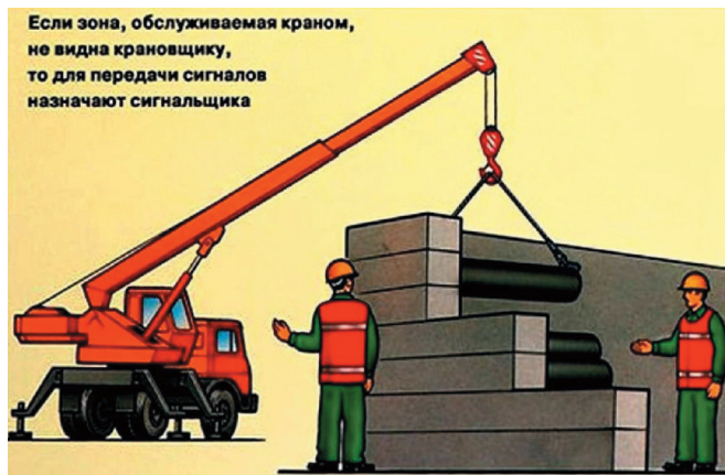
Рис. 3. «Слепые» зоны грузоподъемной машины
