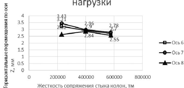
Рис. 6. Зависимость деформаций по оси Z для колонн первого этажа от жесткости соединений колонн при нагрузке от собственного веса
