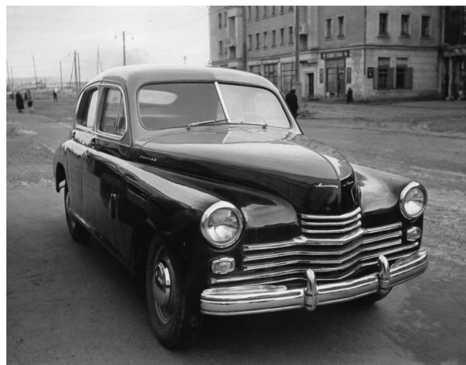
Рис. 1. Первый опытный экземпляр автомобиля «Победа» с 3-х уровневой облицовкой радиатора, именуемой в быту «кремлёвка»
