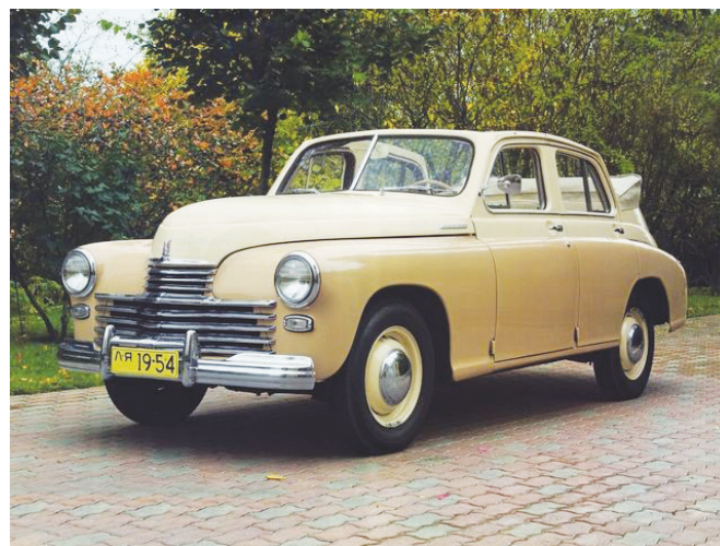
Рис. 2. Автомобиль «Победа» М-20Б кабриолет с серийной 2-х уровневой облицовкой радиатора
