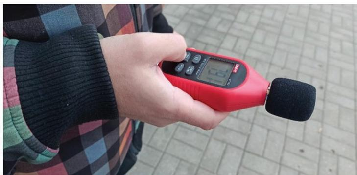
Рис. 2. Натурные измерения уровня звука от транспортного потока по проспекту Ильича
