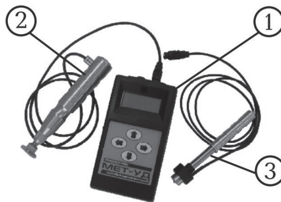
Рис. 1. Твердомер портативный комбинированный МЕТ-УД: 1 – электронный блок; 2 – датчик ультразвуковой У1; 3 – датчик динамический Д1
