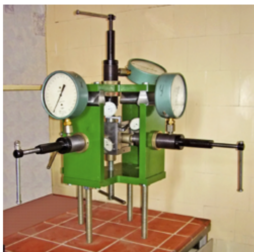
Рис. 5. Прибор трехосного сжатия с независимыми нагружениями по трем осям
