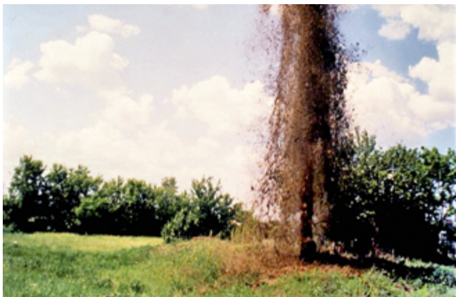
Рис. 4. Испытание по возобновлению дебита скважины, г. Донецк
