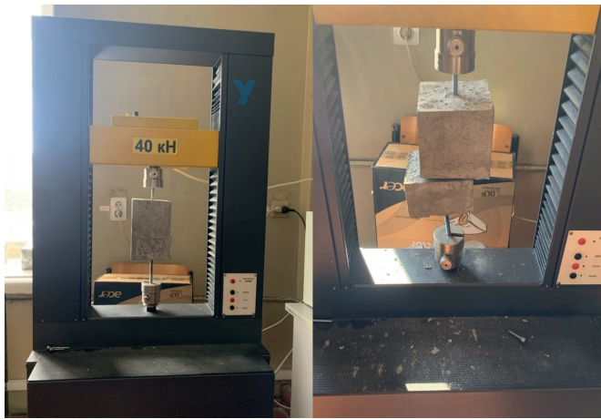
Рис. 10. Испытание образцов на осевое растяжение
