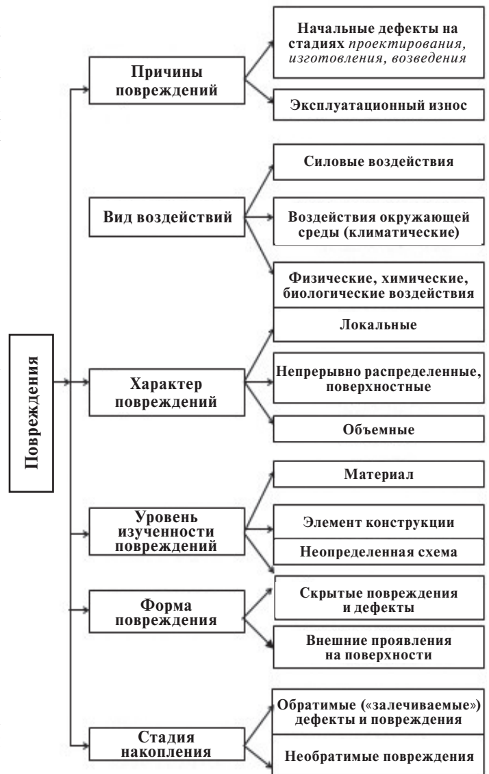
Рис. 1. Общая классификация повреждений железобетонных конструкций
