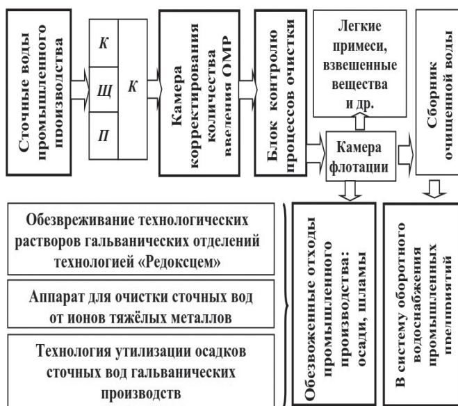
Рис. 2. Блок-схема обработки производственных сточных вод гальванических отделений с использованием реагентов электрохимическими методами. Приёмник-усреднитель стоков: К – концентрированные, К – кислые и П – промывные сточные воды [10, 11, 13-17]
