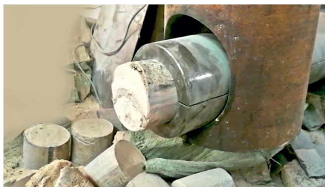
Рис. 1 – Формирование брикетов из регенеративного продукта отхода самоспасателей
