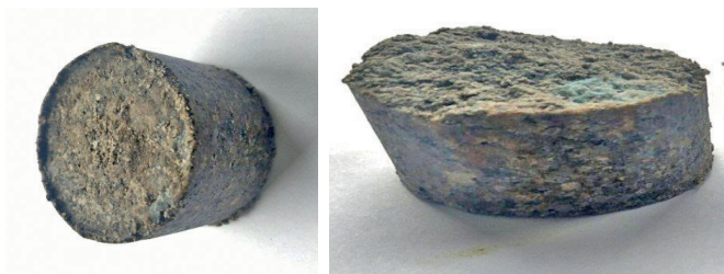
Рис. 2 – Внешний вид первых пробных образцов брикетов удобрения из отходов самоспасателей
