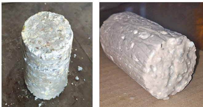
Рис. 4 – Внешний вид брикетов удобрения – карбоната калия, отпрессованных на прессе
