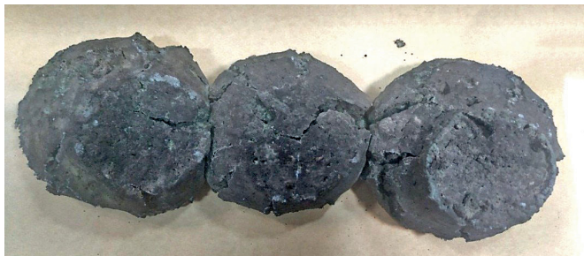
Рис. 3 – Вид брикетов удобрений после сушки (вид сверху)
