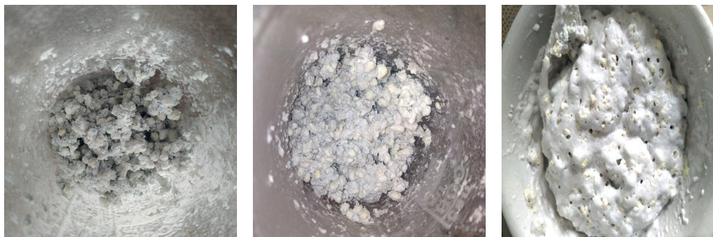
Рис. 5 – Вид отхода регенеративного продукта, обработанного раствором соляной кислоты
