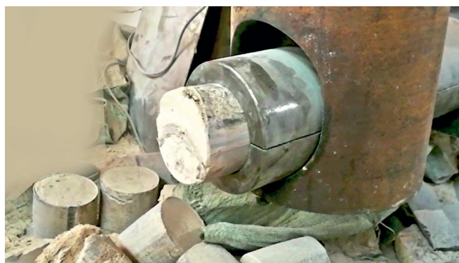
Рис. 1 – Формирование брикетов из регенеративного продукта отхода самоспасателей
