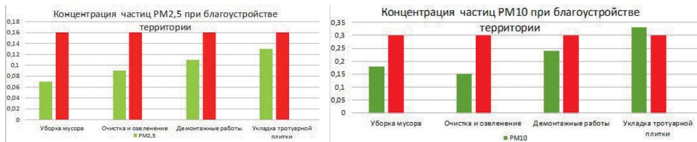
Рис. 2. Диаграммы запыленности PM2.5 и PM10 воздуха городской среды во время работ по благоустройству, в том числе укладки тротуарной плитки
