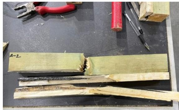
Рисунок 4 – Вид деформаций балки.
