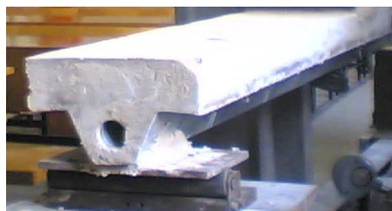
Рисунок 2 – Фрагмент плиты до и после предварительного напряжения арматуры.
