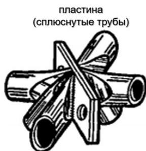
Рисунок 17 – Конструктивные решения «ЦНИИСК».
