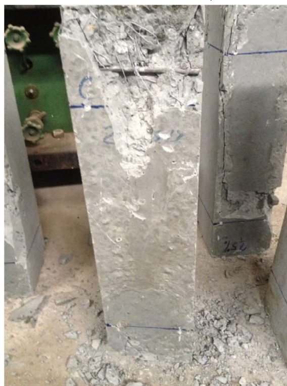
Рисунок 5 – Фиксация характера разрушения образцов из высокопрочного модифицированного бетона с косвенным сетчатым и фибровым армированием.
