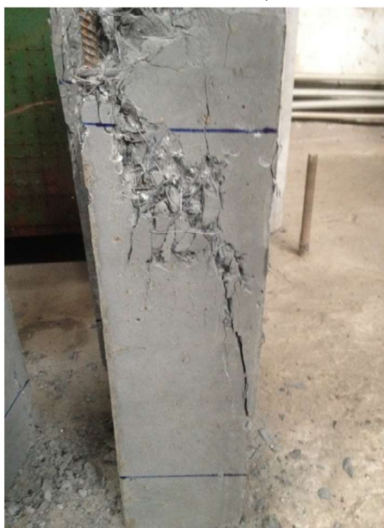
Рисунок 5 – Фиксация характера разрушения образцов из высокопрочного модифицированного бетона с косвенным сетчатым и фибровым армированием.
