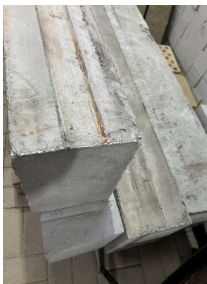
Рисунок 7 – Экспериментальные образцы трехслойных панели с теплоизоляционным слоем на основе полистиролбетона: а) трехслойная панель без декоративного покрытия; б) трехслойная фасадная панель с декоративной поверхностью «серый гранит».
