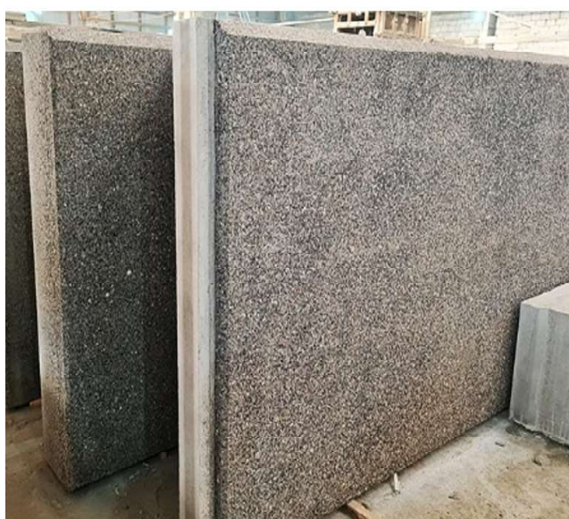
Рисунок 7 – Экспериментальные образцы трехслойных панели с теплоизоляционным слоем на основе полистиролбетона: а) трехслойная панель без декоративного покрытия; б) трехслойная фасадная панель с декоративной поверхностью «серый гранит».
