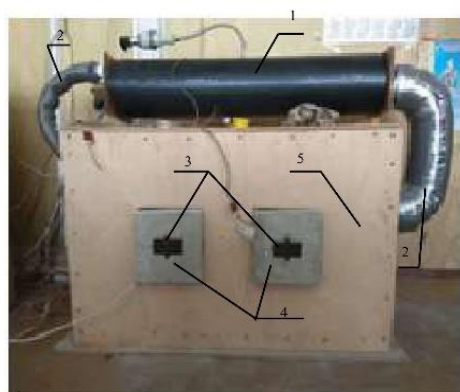
Рис. 1. Установка по измерению прохождения теплового потока.
