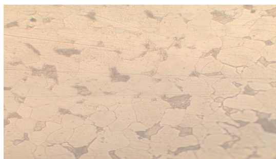
Рис. 1. Исходная структура катанки для холодновысадочной проволоки ( \times 418 \times 2 ).
