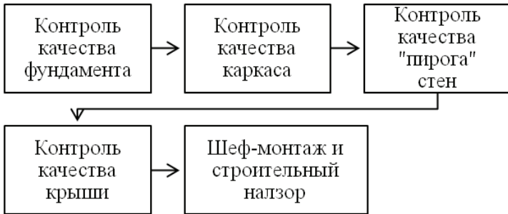
Рисунок – Основные этапы контроля качества при возведении каркасных домов.
