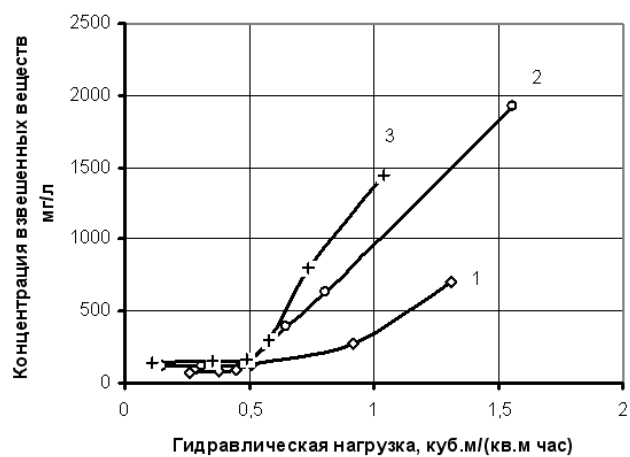
Рисунок 6 — Влияние гидравлической нагрузки на содержание взвешенных веществ в иловой воде на выходе из илоотделителя: 1 — при продолжительности минерализации 13,3 суток; 2 — при продолжительности минерализации 10 суток; 3 — при продолжительности минерализации 6, 7 суток.
