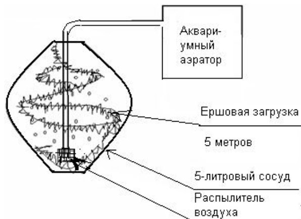
Рисунок 1 — Лабораторная установка по аэрации воды с ершовой волокнистой загрузкой.
