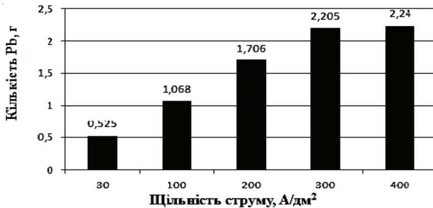
Рисунок 1 – Залежність утворення Pb в електроліті (Pb – 0,2 N, NaOH – 6 N) від щільності струму.
