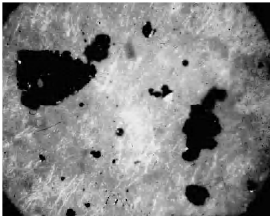
Рисунок 1 – Вид под микроскопом графитсодержащей пыли, увеличение \times 40 раз. Пыль состоит из пластинок графита и брызг металла.
