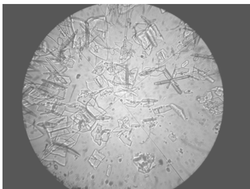
Рисунок 2 – Кристаллы Na_2SO_4 , выпавшие из водного раствора вода-ТСН-5-СН \times 60 .
