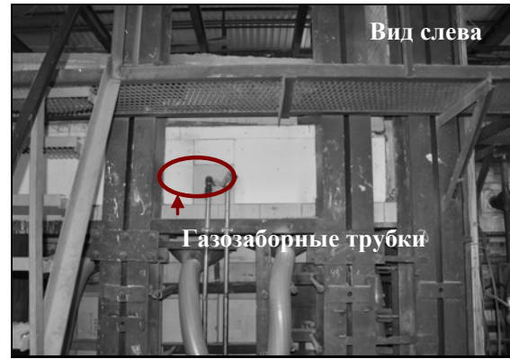
Рисунок 9 – Расположение газозаборных трубок в печи (вид слева).
