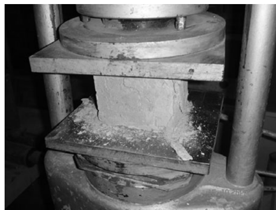
Рисунок 2 – Характер разрушения образца грунтобетона со стальной фиброй.
