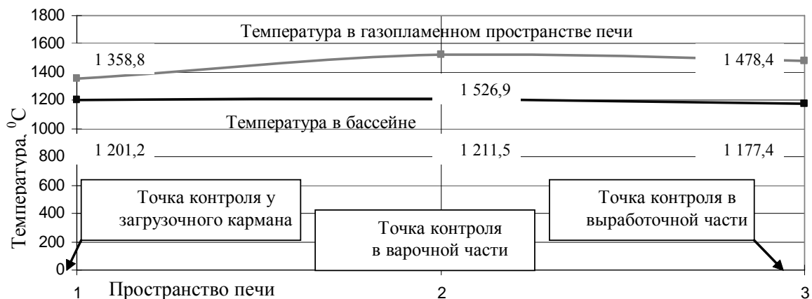
Рисунок 7 – График распространения температур в печи при подаче пламени слева.
