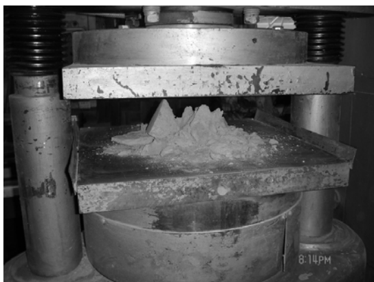
Рисунок 1 – Характер разрушения неармированного образца грунтобетона.
