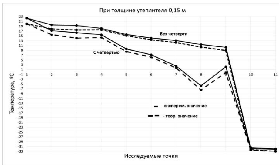
Рисунок 3 – Теоретические и экспериментальные значения температур в исследованных точках, утеплитель толщиной 150 мм.
