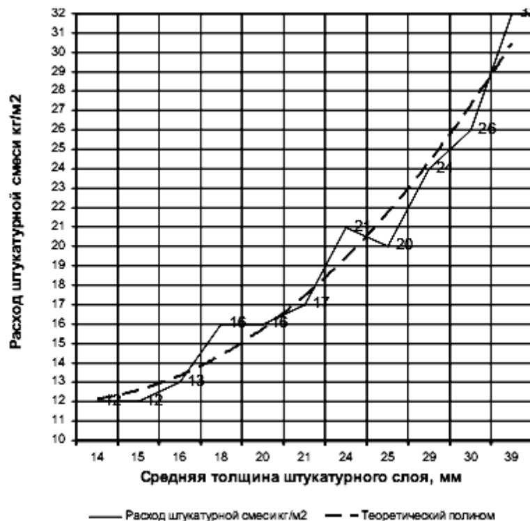
Рисунок 3 – Расход сухой штукатурной смеси кг/м 2 в зависимости от средней толщины штукатурного слоя, мм.
