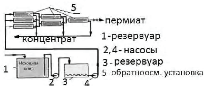
Рисунок 4 – Схема предложенной обратно-осмотической установки.
