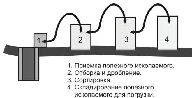
Рисунок 3 – Схема смешанной компоновки технологического комплекса на поверхности шахты [1].
