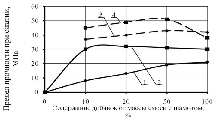
**Рисунок** – Влияние содержания добавок ШКП и термоактивированного каолина на предел прочности камня вяжущих при сжатии: 1, 2 – соответственно вяжущие с добавками ШКП и термоактивированного каолина после 28 суток нормального твердения; 3, 4 – то же и сушки при 110 °С.
