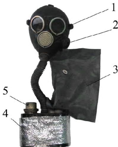
**Рисунок** – Самоспасатель СПО в положении готовности к применению: 1 – маска; 2 – переговорное устройство; 3 – дыхательный мешок; 4 – регенеративный патрон; 5 – пусковое устройство.
