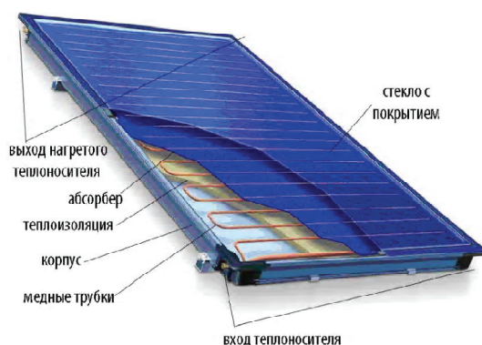
Рисунок 3 – Конструкция плоского солнечного коллектора.
