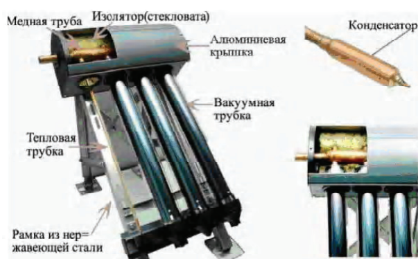
Рисунок 4 – Конструкция вакуумного солнечного коллектора.
