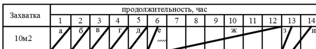
**Рисунок 3** – Циклограммы строительных процессов устройства навесных вентилируемых фасадов с облицовкой керамогранитными плитами видимым и скрытым креплением: а – монтаж лесов; б – монтаж кронштейнов; в – устройство теплоизоляции; г – устройство ветроизоляции; д – монтаж вертикальных профилей; е – обеспыливание, обезжиривание; ж – монтаж керамогранитных плит и планок; з – установка элементов для временной фиксации; и – демонтаж лесов; ~~~~ – технологический перерыв.
