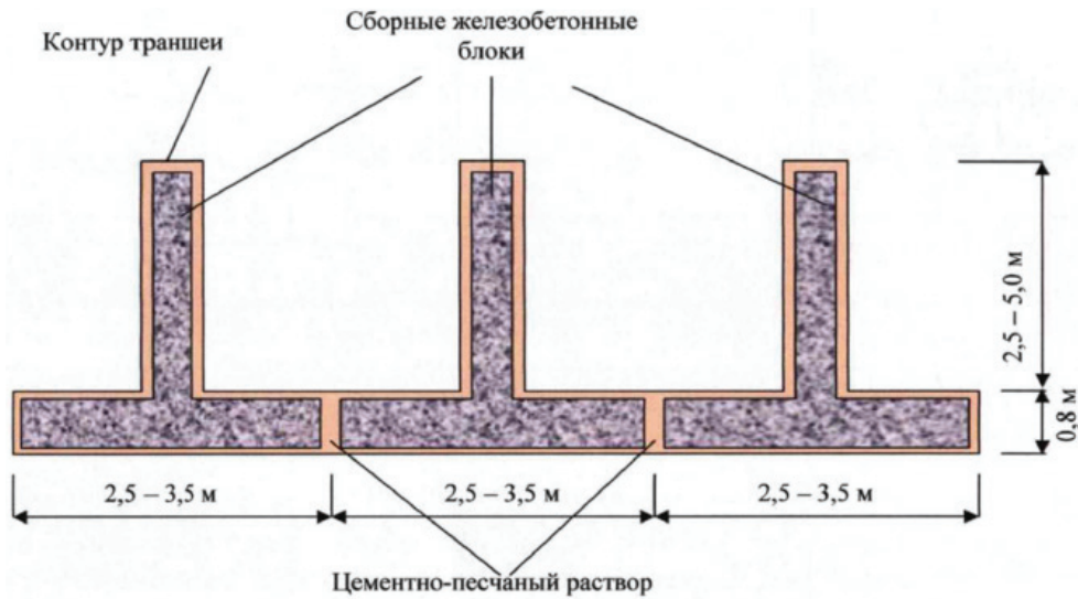
Рисунок 3 – Устройство сборной контрфорсных «стен в грунте» [4].
