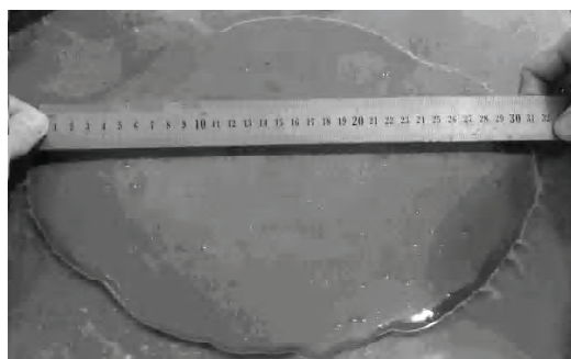
Рисунок 1 – Определение подвижности цементно-зольных паст
