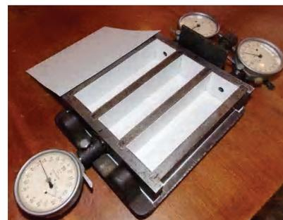
Рисунок 1 – Форма для определения линейной деформаций аутогенной усадки образцов с размерами поперечного сечения 40×40 мм.
