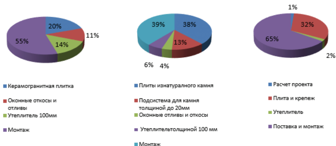
Рисунок 3 – Распределение издержек на технологические операции при устройстве вентилируемых фасадов из различных материалов.
