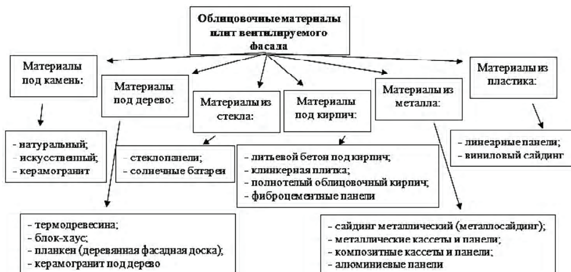
Рисунок 2 – Классификация видов облицовочных плит для вентилируемых фасадов.
