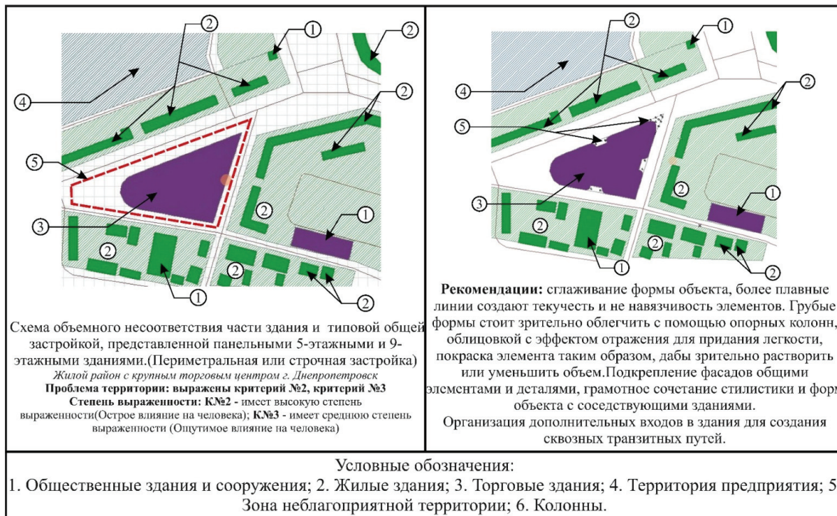
Рисунок 6 – Схема объемного несоответствия всего объема здания или его части с типовой жилой застройкой, представленной панельными 5-этажными и 9-этажными зданиями.
