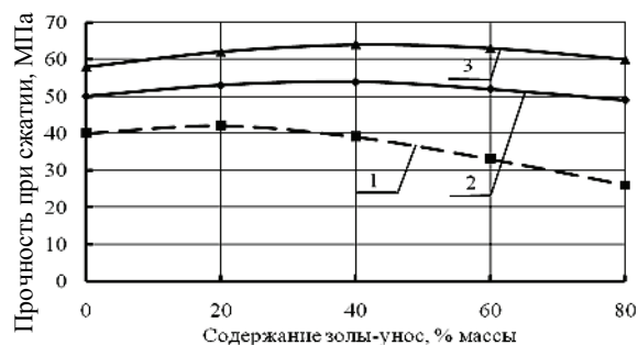
Рисунок 8 – Зависимость активности автоклавированных вяжущих от плотности раствора гидроксида натрия и содержания молотого шлака ТЭС: 1, 2, 3 – соответственно плотность 1,15, 1,20 и 1,25 г/см³.
