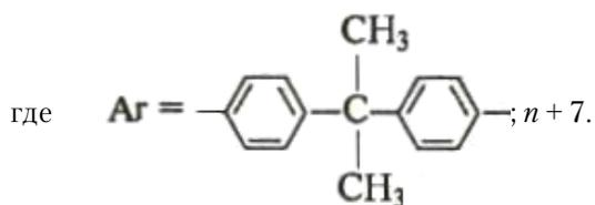
Эпоксисмолачные смолы получают при совместном нагревании эпихлоргидрина и новолачных смол (фенолформальдегидных). Новолачные смолы получают в кислой среде в присутствии катализаторов – соляной, щавелевой кислот, реже  $\text{H}_2\text{SO}_4$ , при избытке фенола. Новолачные смолы – линейные олигомеры, в молекулах которых фенольные ядра соединены друг с другом метиленовыми мостиками.
