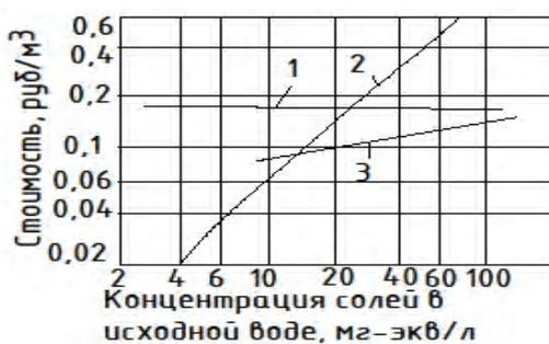
**Рисунок 1** – Стоимость опреснения воды различными способами при разном соледержании: 1 – дистилляция; 2 – электродиализ; 3 – химическое обессоливание (ионообмен).
