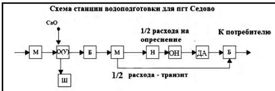
**Рисунок 3** – Схема очистных сооружений для усовершенствования водоснабжения пгт Седово: О (У) – отстойник-известковый умягчитель; Б – бак с перекачивающими насосами; М – механический фильтр; Н – водород-катионирование; ОН – катионирование; ДА – деаэрактор; Ш – шламонакопитель.
