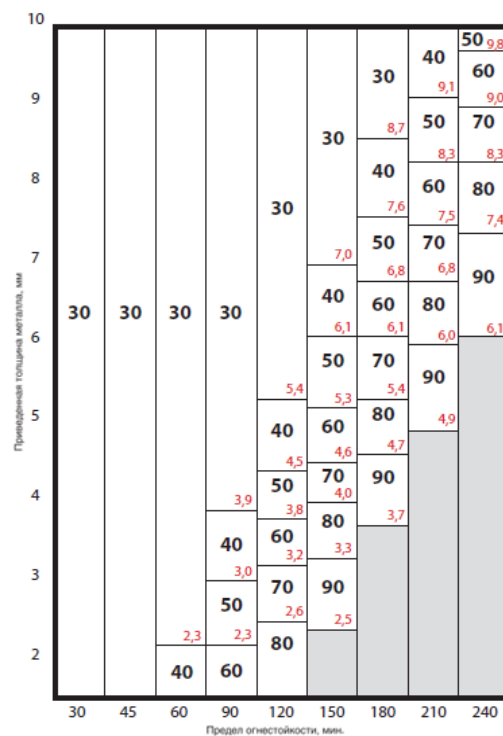
Рисунок 2 – Толщина огнезащитной изоляции ТЕХНОНИКОЛЬ в зависимости от предела огнестойкости и приведенной толщины металла.
