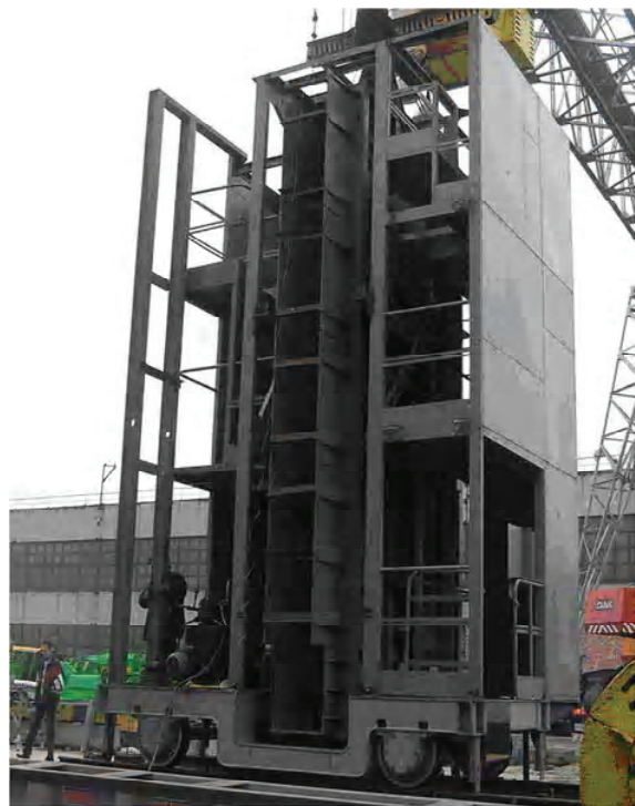
Рисунок 1 – Металлоконструкция коксонаправляющей двересъемной машины.
