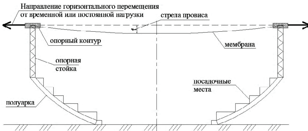
Рисунок 3 – Рассматриваемая конструктивная форма покрытия.
