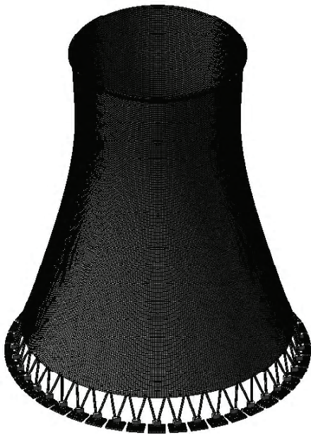
Рисунок 1 – Пространственная расчетная схема оболочки башенной градирни H = 150 м (111 387 – узлов, 110 680 – элементов).
