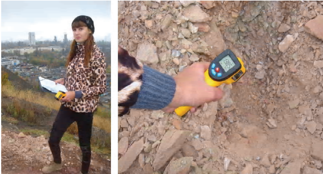
Рисунок 2 – Фото с места (очаг № 1) проведения температурной съёмки на отвале горных пород ОП «Шахта им. М. И. Калинина» ГП «Макеевуголь» в сентябре 2019 года.
