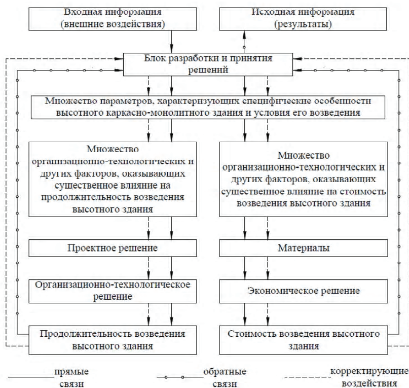
Рисунок 1 – Модель системы обоснования организационно-технологических решений возведения высотных каркасно-монолитных зданий.
